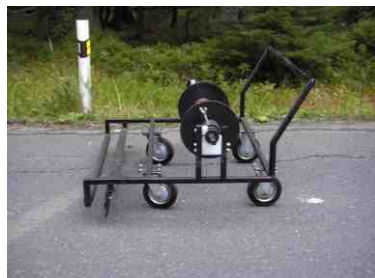
Zařízení pro ruční strojovou pokládku; pokládka pomocí tohoto zařízení; pokládka výztuže o šíři 95cm.
