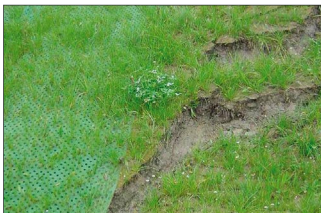
Protierozní účinek Envirofeltu PP (vlevo zabezpečená část, vpravo bez aplikace)
